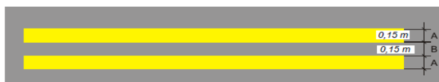
Gambar 5.2- 38 Apron Edge Markings
